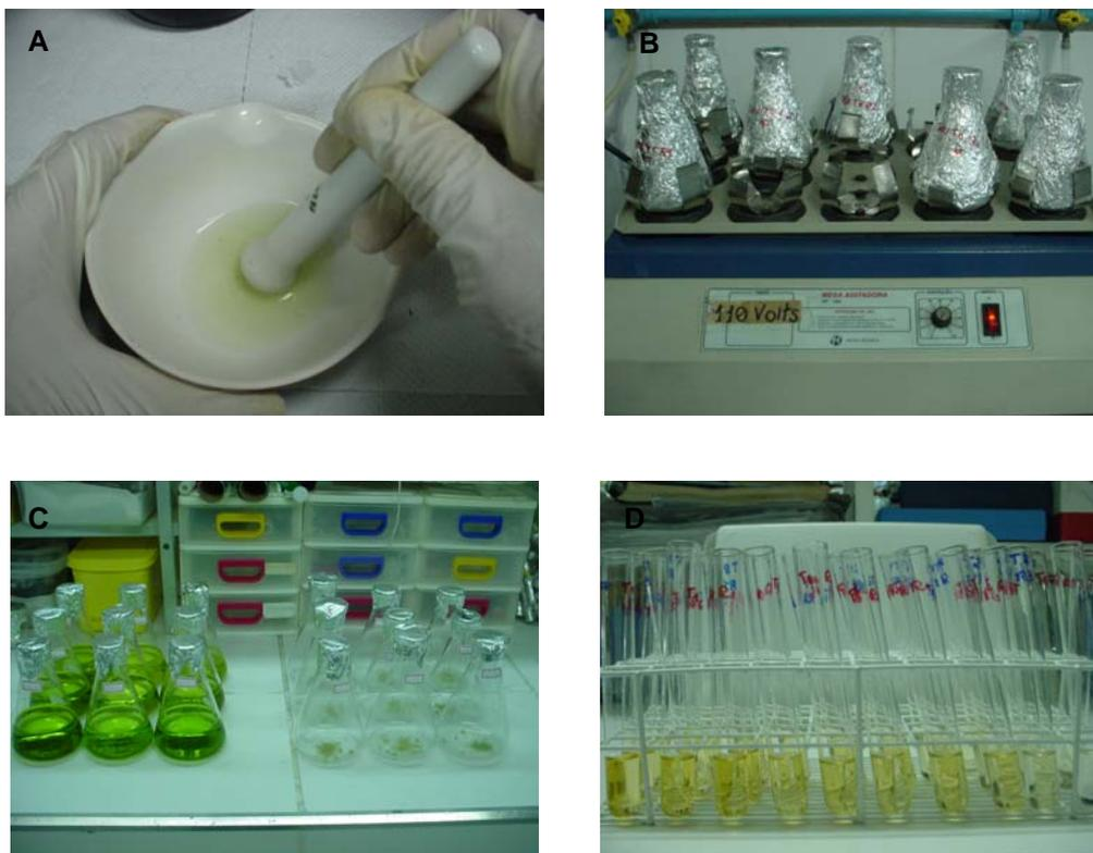
Figura 3: Etapas da extração dos lipídeos: (A) maceração da biomassa, (B) extração com solvente em mesa agitadora, (C) separação da biomassa celular após a extração
