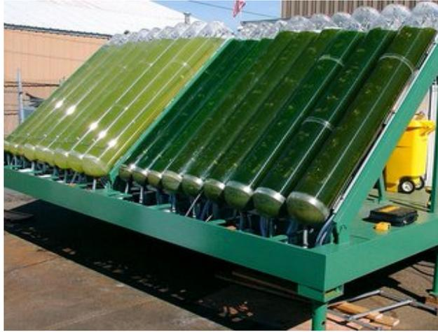
Figura 2: Sistema de cultivo fechado externo (fotobiorreator). Fonte: [wttp://energiasrenovaveis.wordpress.com](http://energiasrenovaveis.wordpress.com)
