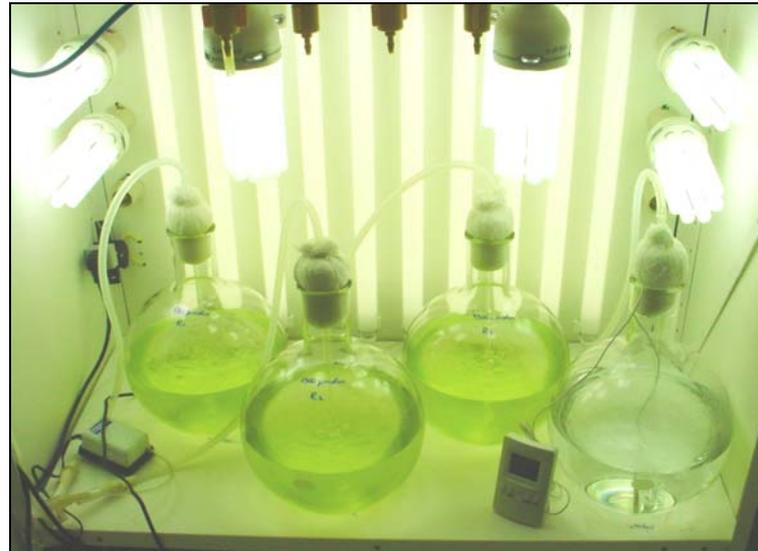
Figura 5: Arranjo do conjunto de lâmpadas fluorescentes usadas nos experimentos com intensidades luminosas iniciais de 900, 1300 e 2000  $\mu\text{moles.m}^2.\text{s}^{-1}$  respectivamente.
